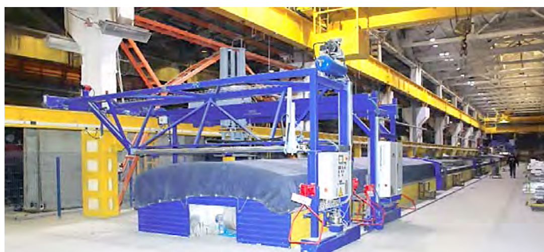
Линии поворотных столов для изготовления трехслойных наружных стен с тепловой обработкой изделий продуктами сгорания природного газа
